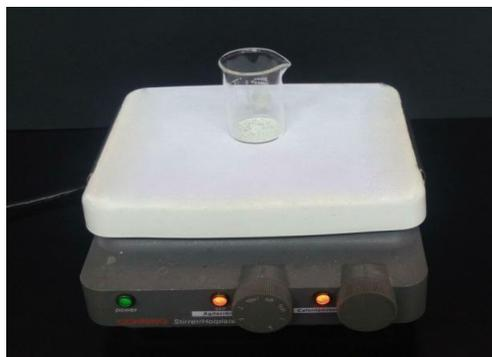
4. Con ayuda de las pinzas para tubo de ensayo, se retira de la parrilla el vaso y se coloca en la superficie metálica de la tarja para que alcance la temperatura ambiente.
